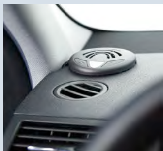
Hangszóró LED-es kijelzővel (akusztikus és vizuális figyelmeztetés)
